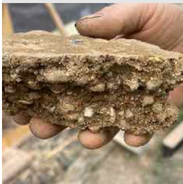
Miestnu hlinu treba otestovať, spraviť vzorky s rôznymi pomermi plniva, aby sme určili vhodnú zmes.
