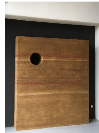
Nenosná priečka z ubíjanej hliny.
